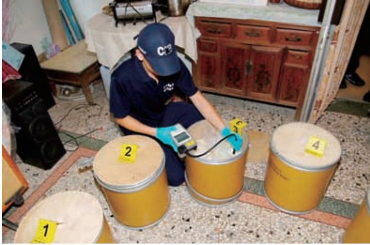
製毒工廠現場使用拉曼光譜儀初篩檢測
